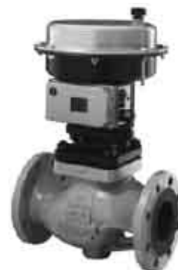
Проходной клапан V2001-P Ду 80 с пневматическим приводом 350см2 и позиционером тип 3730
