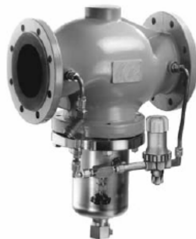
Редукционный клапан тип 2333 (Ду 150) с дополнительным управляющим клапаном тип 50ES
