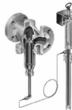
Клапан тип 4 с регулирующим термостатом тип 2231 (вид в сечении)
