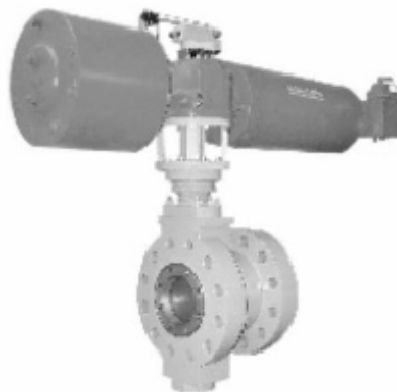
Регулирующая заслонка высокого давления Leusch Тип LTR 43 в двухфланцевом корпусе 10", ANSI Class 1500 с пневмоприводом и позиционером
